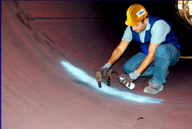
Esame magnetoscopico su saldature di lamiera
