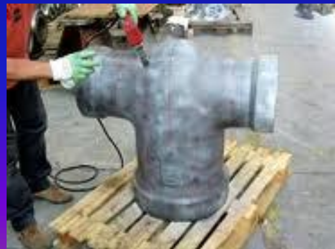
Esame magnetoscopico su valvola a "tre vie"
