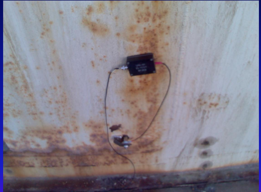
Sensore di emissione acustica (in basso) collegato ad un preamplificatore (in alto)
